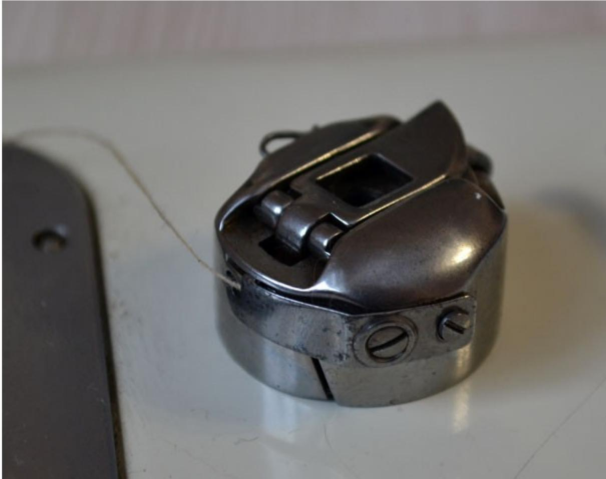
Die Qualität der Stichbildung wird nicht nur durch die Einstellung des Greifers beeinflusst, sondern auch durch eine Reihe von sekundären Faktoren. Vor allem die Einstellung der Unterfadenspannung ist wichtig.
